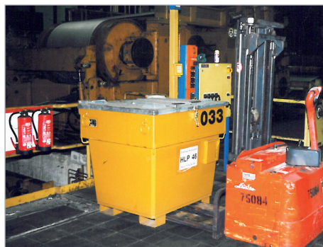
Mobile Öl-Versorgung von Maschinen
