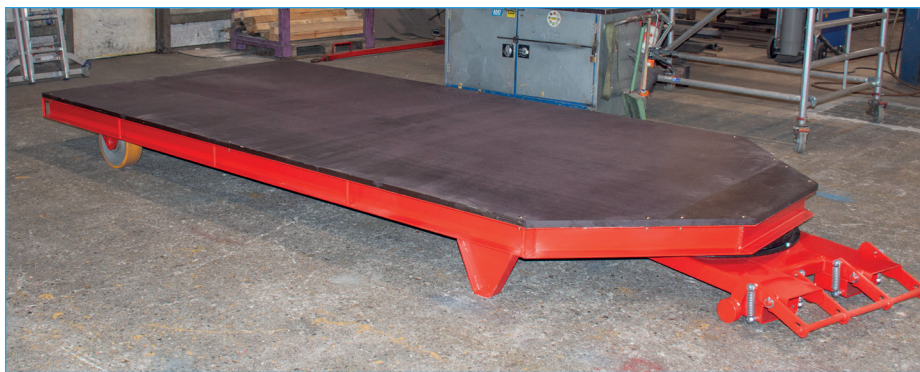
STS met anti-slip betonplexplaten
