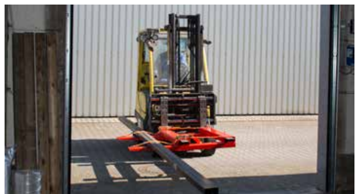
Eenvoudig passeren door poorten en gangen bij het transport van langgoedmateriaal met de LSL
