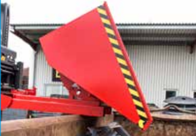
Afrolmechanisme met automatische ontgrendeling
