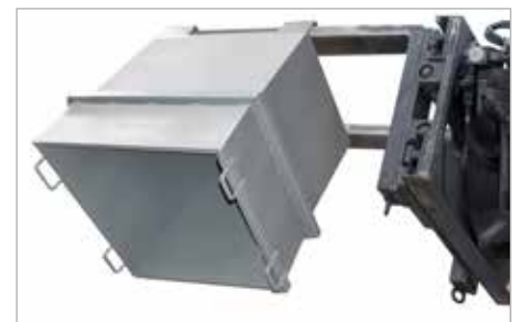
UC-lediging met heftruck-draaikrans
