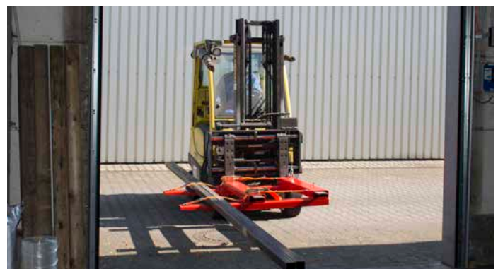
Passage de portails simplifié avec de grandes longueurs, d'allées grâce au type LSL
