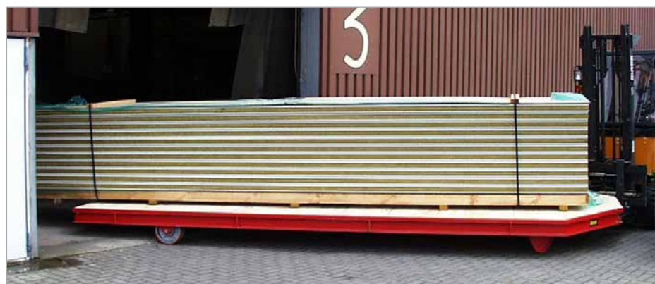
Transport de charges longues, rayon de braquage minimal grâce à la prise directe
