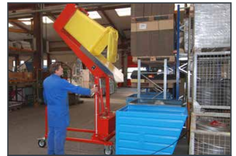
Manutention de poubelles
