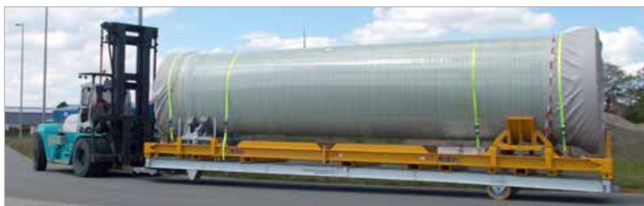
Voor het transport van extreem zware en volumineuze delen: lengte 12 meter, draagkracht 20t
