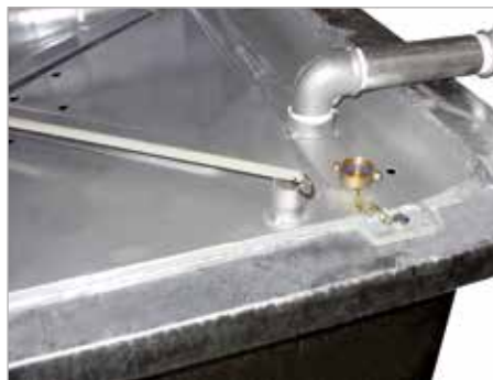
Peilstok voor vulstandcontrole
