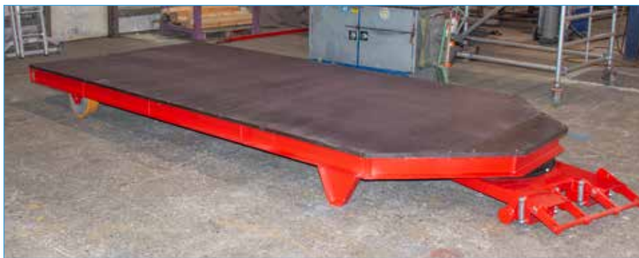
STS met anti-slip betonplexplaten
