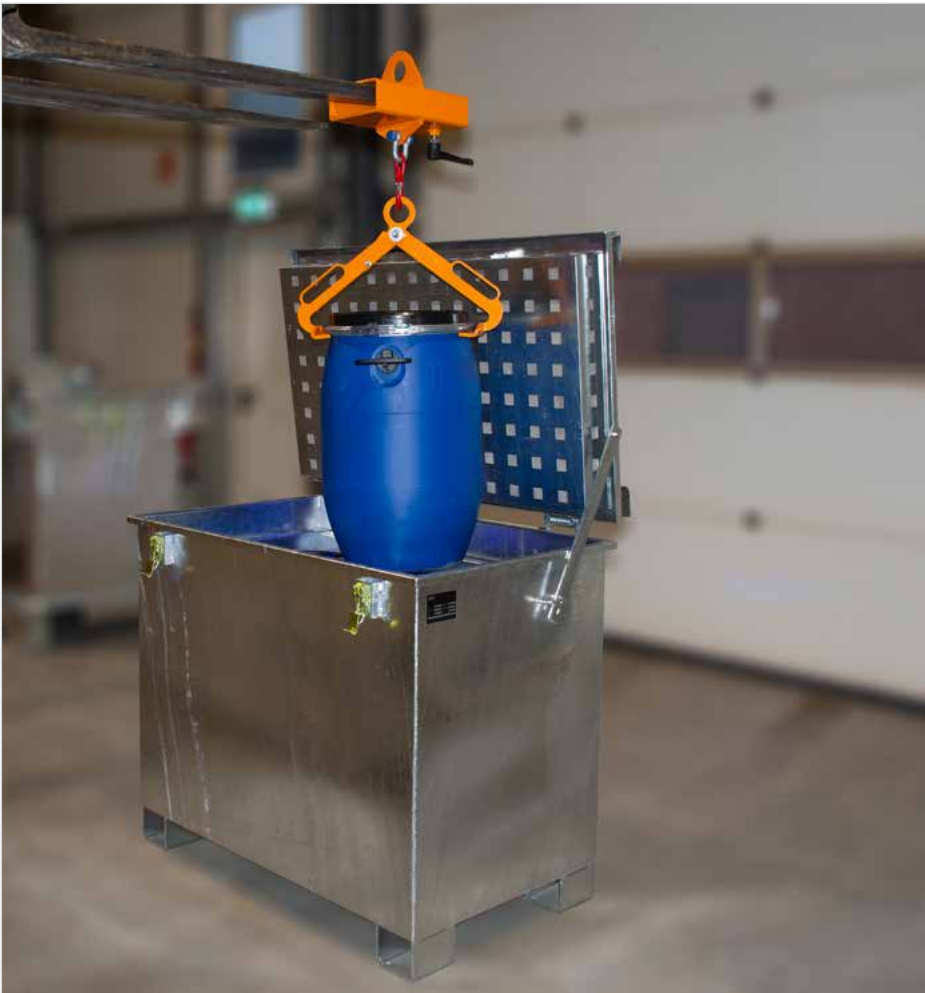
LIL 340 uitnemen van een 60-liter dekselvat met klemring met behulp van lasthaken type LH-I en vatentang LGZ 60 (zie heftruck aanbouwapparatuur)
