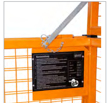
Beveiligingen van de neerklapbare beschermroosters
