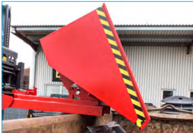
Afrolmechanisme met automatische ontgrendeling
