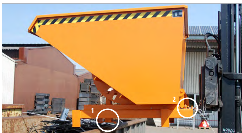
① automatische ontgrendeling, of...
