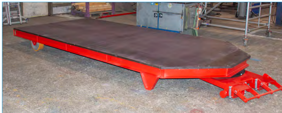
STS met anti-slip betonplexplaten
