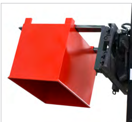
lediging met draaikrans van de heftruck
