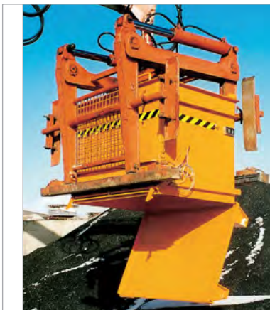
BC met steentangontgrendeling
