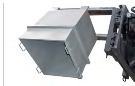
UC-lediging met heftruck-draaikrans
